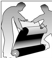
Idealerweise werden die KÖSTER Bikuplan® KSK AW 15 Dichtungsbahnen zu zweit verarbeitet. Die Dichtungsbahnen werden passend zugeschnitten und an der Außenwand ausgerichtet. Durch vorsichtiges Abziehen der rückseitigen Schutzfolie wird die Bahn blasen- und faltenfrei angeklebt und mit einer Andrückrolle fest angerollt.
